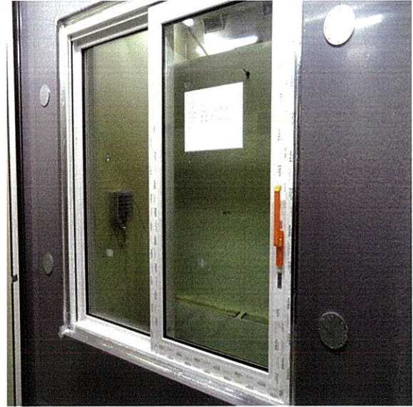
<사진 2> 열관류율 저온측 시험체 모습
