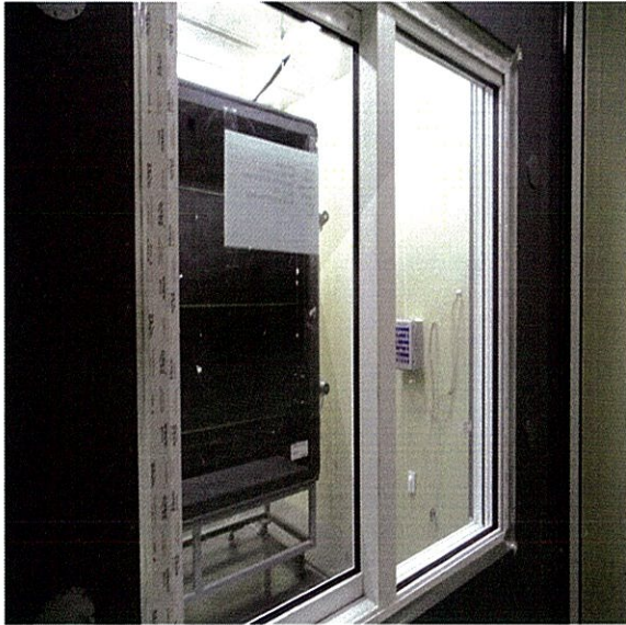
<사진 1> 열관류율 향온측 시험체 모습
